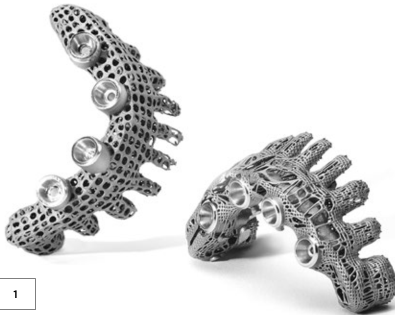
Fig. 1. Esempi di lavorazioni in ripresa su strutture stampate in 3D. Immagini su gentile concessione di TQM e Dr. Domenico Benagiano.
