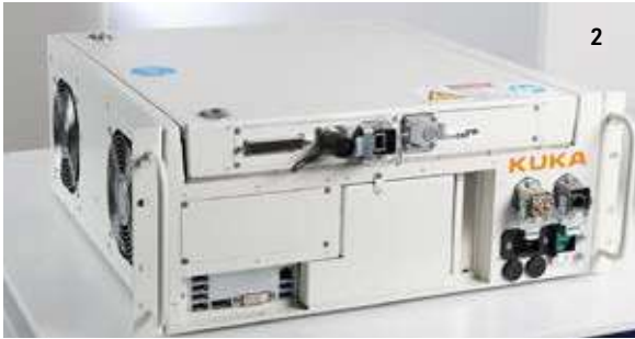
Fig. 2 Esempio di Cabinet o Unità di controllo di un robot.
