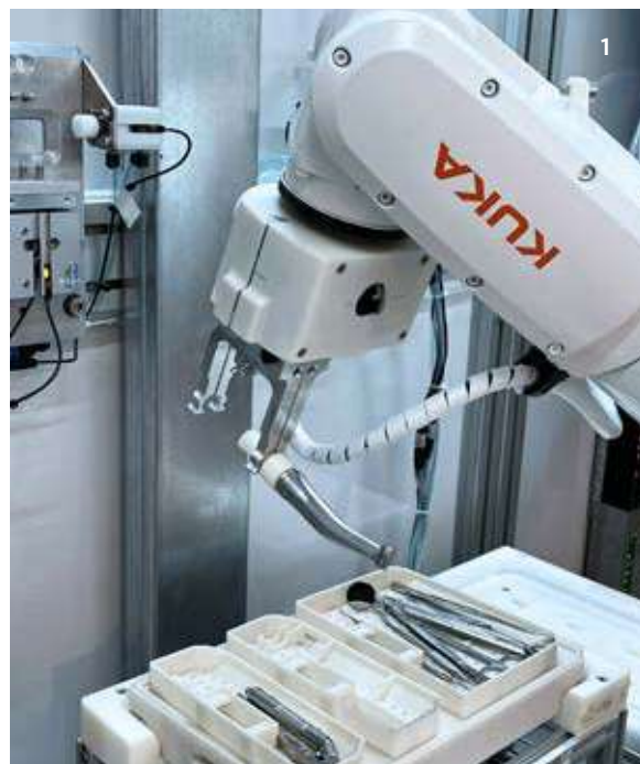
Fig. 1 Gestione dello strumentario attraverso un braccio robotico antropomorfo.
