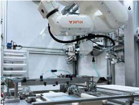
Fig. 6 Visione della cella di sterilizzazione e della stazione di imbustamento automatizzata.
