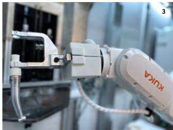
Fig. 3 Esempio di end effector specializzato nella manipolazione dello strumentario odontoiatrico.
