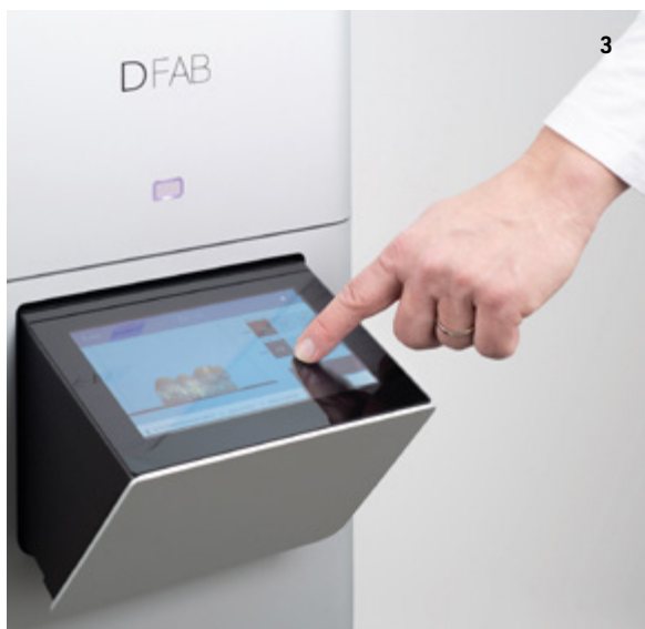
Fig. 3. Attraverso il software Nauta Photoshade, l'operatore può impostare sul modello 3D del restauro, in maniera agile e veloce, la posizione e l'ampiezza della sfumatura di colore desiderata.
