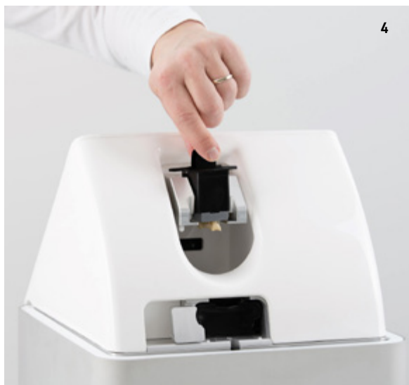
Fig. 4. Rimozione del piatto di stampa, a processo ultimato. I supporti saranno quindi rimossi ed i restauri saranno lavati in apposita vaschetta.
