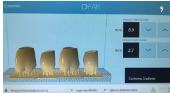
Fig. 7. Screenshot del software di DFAB® Photoshade per il settaggio dei gradienti colore.
