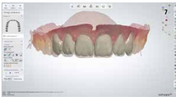
Fig. 5. Al termine delle preparazioni sono state realizzate le scansioni intraorali delle arcate dentarie di cui in figura si evidenzia l'allineamento del piano oclusale in ambiente CAD (Dental System Premium 3Shape, Copenhagen, Denmark). Data la cospicua modifica di forme e volumi, si è optato per disilicato di litio, stratificato, preferendolo alla ceramica feldspatica in virtù della maggiore resistenza alla flessione.
