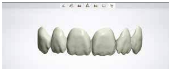
Figg. 7-8-9. Progettazione digitale dei sottili gusci attraverso il cut-back per le masse ceramiche.
