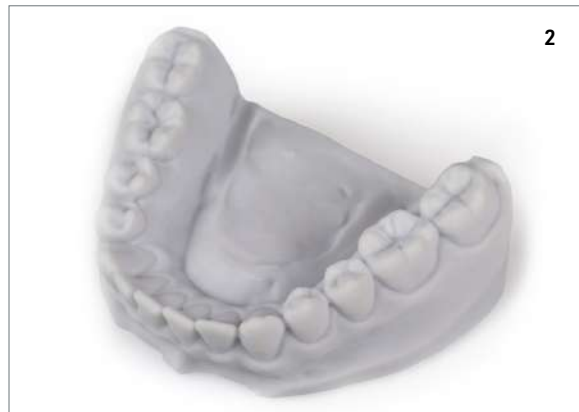
Fig. 2. I modelli stampati con macchina professionale SLA sono estremamente accurati, riproducono la superficie dei denti in dettaglio, e sono pertanto ideali anche per le applicazioni protesiche.
