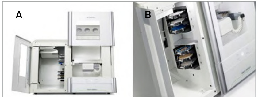
Figura 4. DWX-52DCi® (DGS SHAPE, a Roland Company) permette di fresare zirconia, cera, PMMA, resina composita (in disco o in blocchi), PEEK, gesso, cromocobalto pre-sinterizzato, fibra di vetro. La peculiarità di questa macchina consiste nell'aver, oltre al cambio utensile, anche il cambio del disco automatico, con 6 dischi disponibili.
